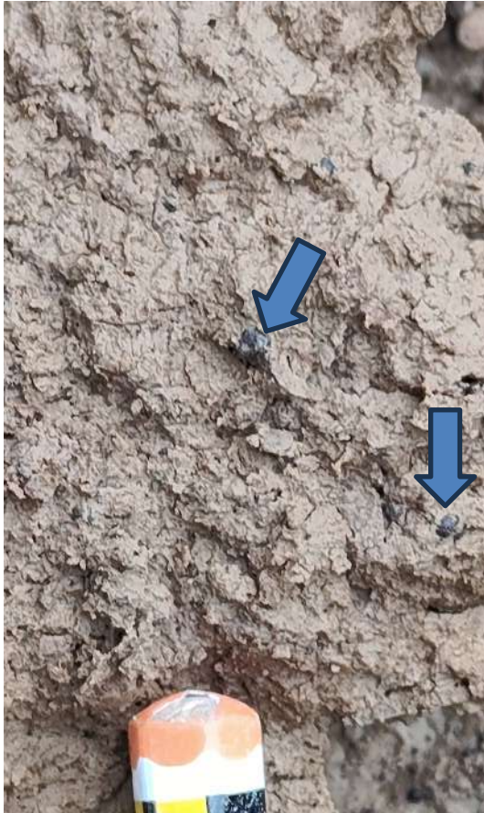
Slika 5a, b: Plast 1 na sliki 4. Levo: naravni lom, koluvalna plast, pretežno meljasta, po nastanku preperina dolomita. Vidni so posamezni (mikro)gomolji železovega hidroksida, limonita, veliki do 2 mm. Desno, izprana površina plasti 1 s slike 4. Limonitni gomolji so bolj vidni. Svinčnik na sliki ima premer 8 mm. Vir železa je verjetno so verjetno tla poligenetska izvora, kraška rdeča tla, »terra rossa«.
